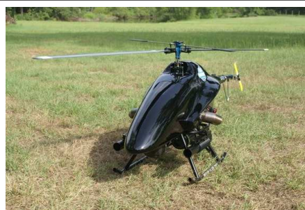
Drone hélicoptère avec deux lance-grenades de 40mm de type M203 (non-rechargeable en vol)
